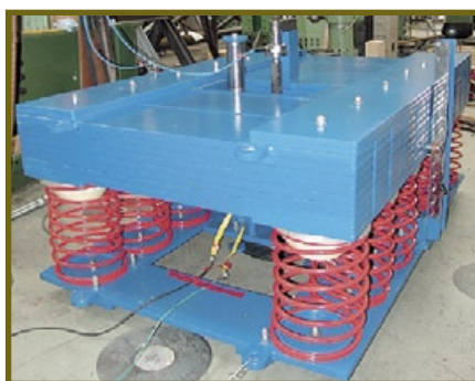
Fot. 3. Jeden z 12 adaptacyjnych tłumików sejsmicznych zastosowanych do stabilizacji mostu w Wołgogradzie opracowany przez inż. Marcina Maślankę z AGH. Masa tłumika 5,2 tony
