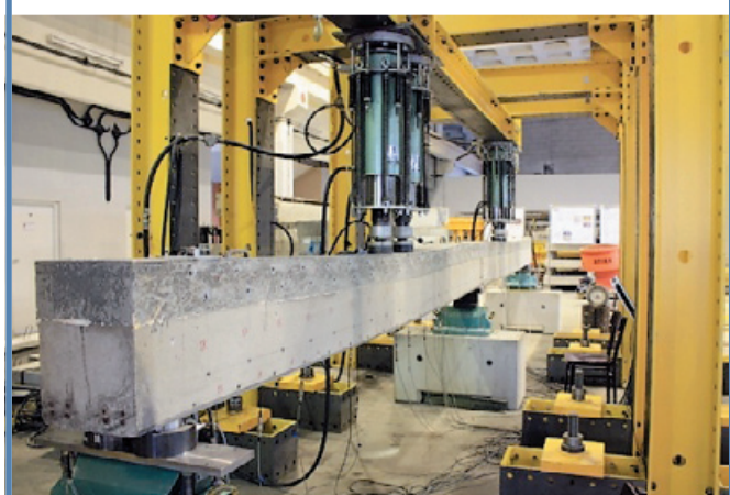
Fot. 5. Element serii III w trakcie przygotowania do badań i na stanowisku badawczym
