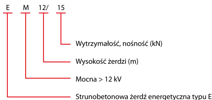
Ryc. 6. Opis oznaczeń żerdzi strunobetonowych wirowanych- inny przykład [4]
