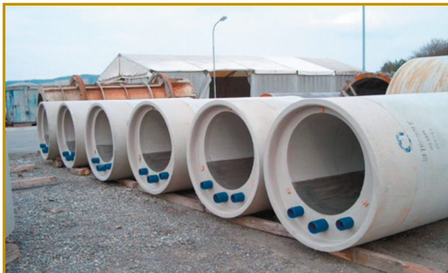
Fot. 1. Rury z wbudowanym wymiennikiem ciepła [4]
