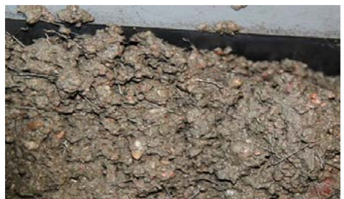
Ryc. 5. Mieszanka betonowa ze zbrojeniem rozproszonym typu DRAMIX
