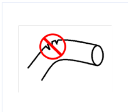
Ryc. 8. Kabel o niepoprawnym promieniu gięcia - doszło do degradacji izolacji
