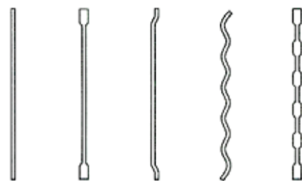
Ryc. 4. Typowe kształty włókien stalowych stosowanych do betonu
