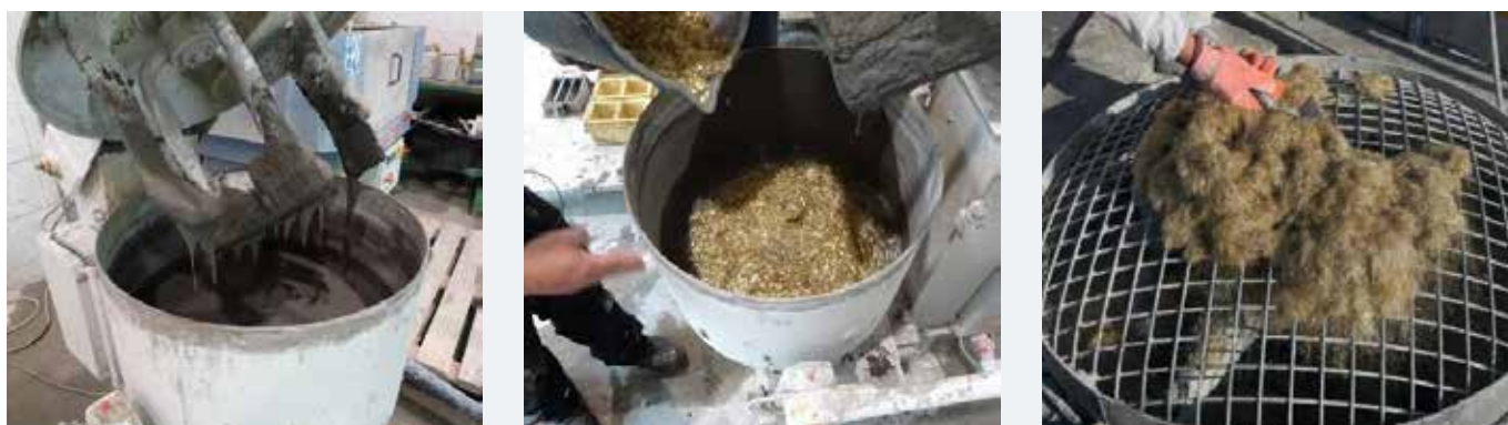
Rys. 14. Przygotowywanie mieszanki UHPC w warunkach laboratoryjnych: a) mieszanka przed dodaniem włókien, b) dodawanie stalowych włókien, c) dodawanie włókien na placu budowy
