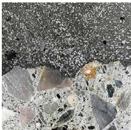
Rys. 10. Szczegół styku betonu zwykłego (NC) i ultrawysokowartościowego (UHPC)
