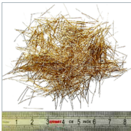
Rys. 11. Mikrowłókna stalowe firmy KrampeHarex DM12.5/0.175 o długości l_f = 12,5 mm i średnicy d_f = 0,175 mm
