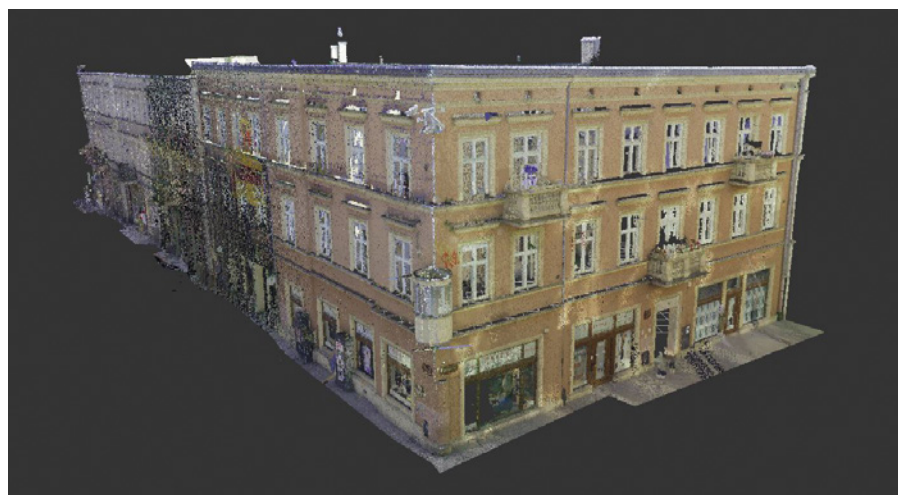
Rys. 3. Kamienica przy ul. Piotrkowskiej 34 w postaci chmury punktów
