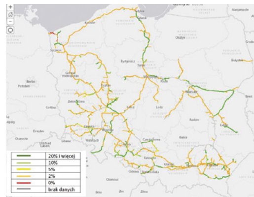
Rys. 1. Mapa dopuszczalnych ilości wodoru w poszczególnych odcinkach systemu przesyłowego z uwzględnieniem analizy struktury i składu chemicznego stali [10]
