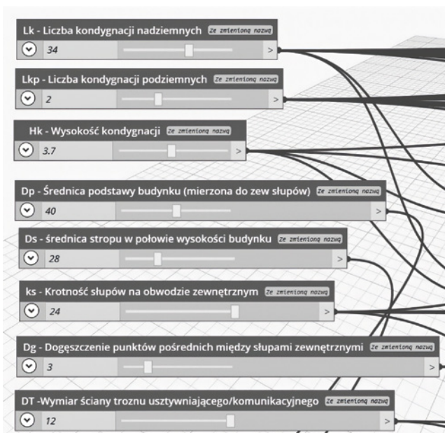
Rys. 2. Przykład definicji parametrów wejściowych w programie Dynamo Sandbox
